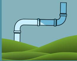
O sistema de distribuição das águas cinzas deverá ter coloração diferenciada, para facilitar em processos de manutenção.
